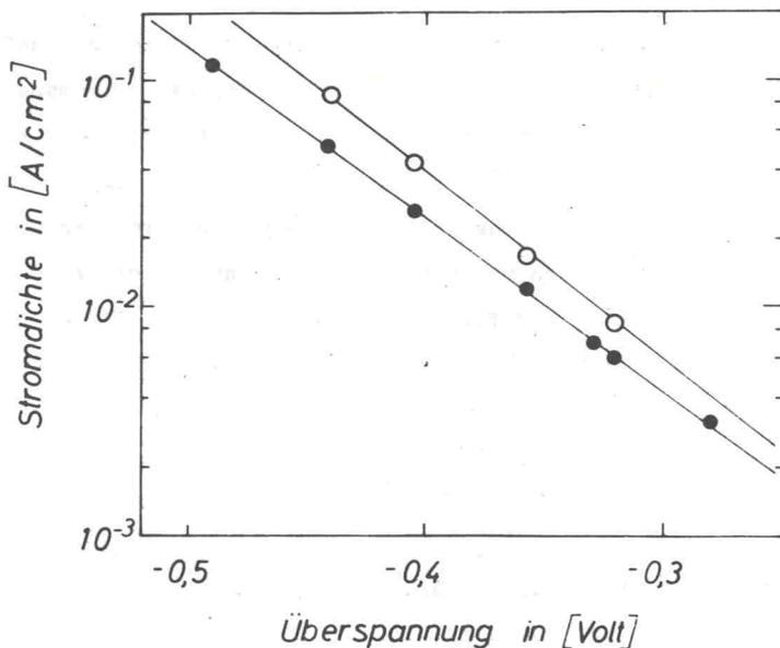
Abb. 27. Stationäre Stromspannungskurve (●) und Anfangsstromspannungskurve (○) für die Wasserstoffabscheidung an Gold aus 1 m Perchlorsäure + 1 m Natriumperchlorat bei Atmosphärendruck
